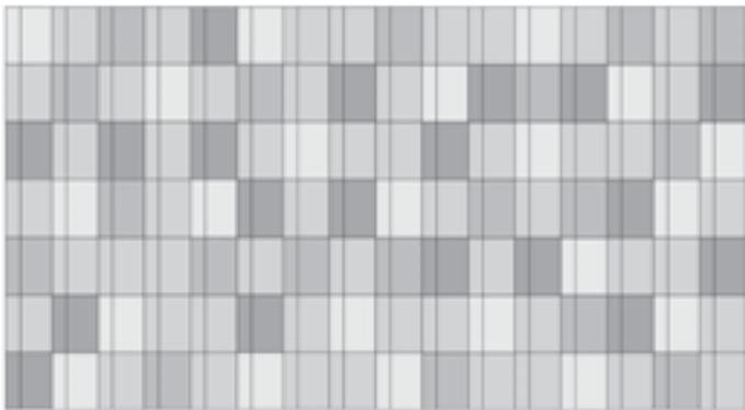
***Nota: Para techados de tejas 'Mission' de múltiples colores el instalador debe tener cuidado de distribuir los colores de tal forma que las tejas canales y las tejas cobijas adyacentes se mezclen al azar.***
