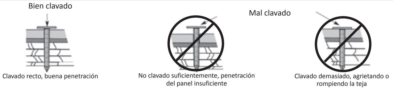
Figura 15.1: Técnicas apropiadas para clavar paneles de madera contrachapada
