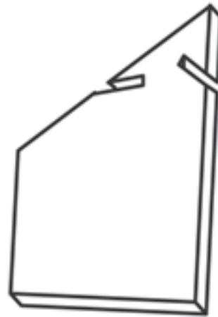
Figura 19.1: Ejemplos de tejas cortadas y ranuradas
